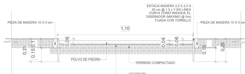
DETALLE DE SENDERO - SECCIÓN A-A ESCALA 1:10
